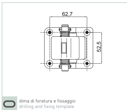
O dima di foratura e fissaggio drilling and fixing template
